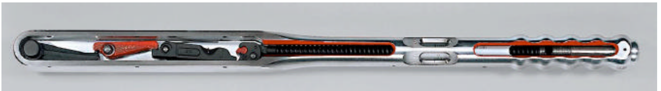
Fig. 3. Spaccato di una chiave dinamometrica a scatto
